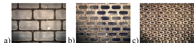
Bild 8 Stromkollektoren mit Öffnungen mit einem Mittenabstand von 2x1 mm, 1x0,5 mm und 0,6x0,3 mm
